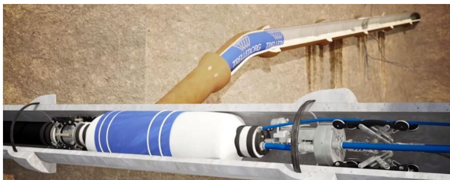
Slika 35. Princip sanacije „T-line“ metodom
